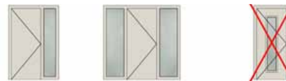
Abb. 66 | Eingangstüren mit geschlossenen Türblättern
